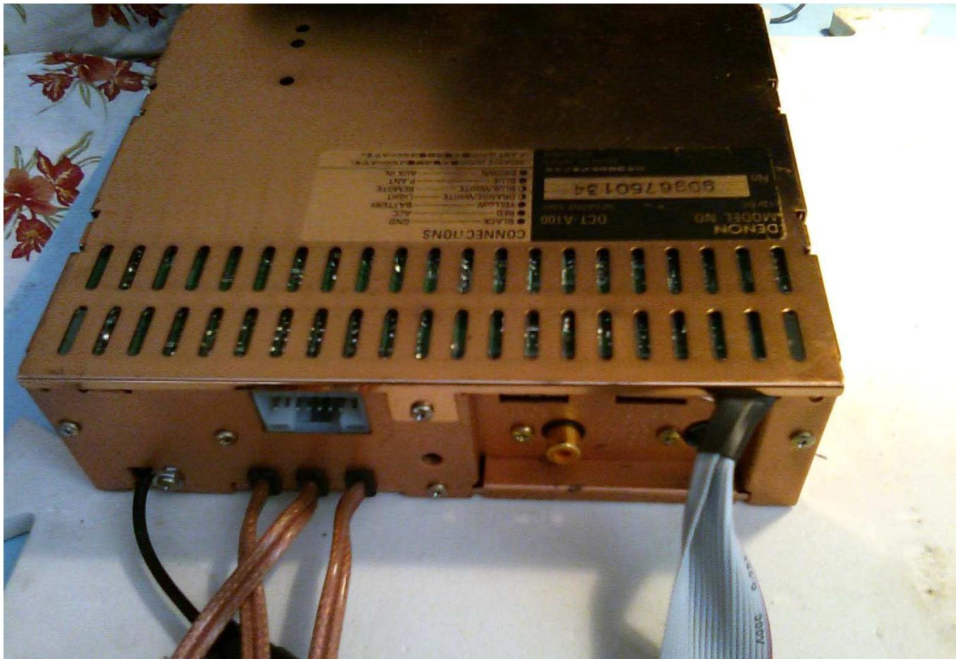
Место выхода жгута из корпуса дополнительно изолируется от металла задней стенки и закрепляется термоклеем. Жгут соединяется с блоком.
