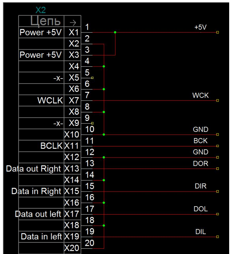
Для подключения необходимо открутить четыре винта крышки проигрывателя CD, снять крышку. Осторожно вытащить плату из корпуса. Затем аккуратно отсоединяем плату ЦАП от разъёмов на основной плате. Все подключения будут производиться на этой плате. Схема подключения показана на рис. 3:
