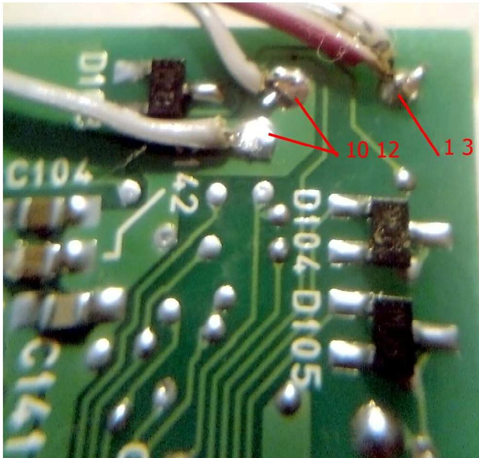
После тщательной проверки и прозвонки тестером всех цепей на правильное подключение и отсутствие замыканий на соседние дорожки (лучше проверить дважды!), закрепляем провода термоклеем к плате ЦАП.
