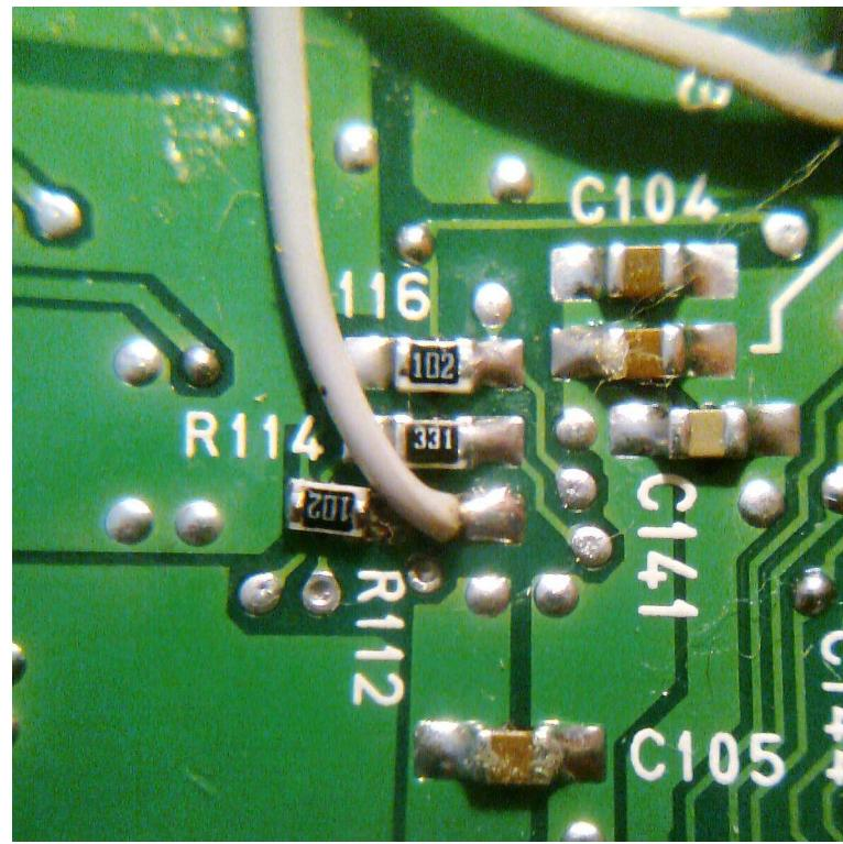
Массовые провода (номер 10 и 12) припаиваются к выводам цифровой земли микросхемы ЦФ в районе контактов конденсатора С 106. Там же припаиваются провода питания (номер 1 и 3):
