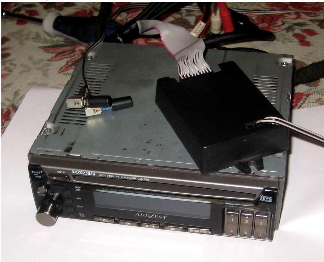
На боковой стороне блока расположены 16 дип – переключателей, пронумерованных слева направо S1 – S16. На дополнительный разъем выведены контакты первого и второго переключателей.
